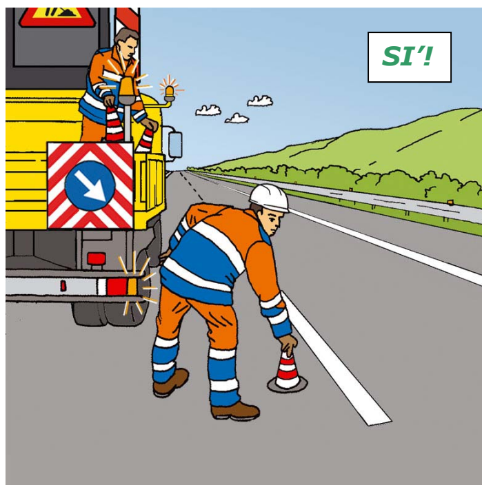
Figura 59 – Posizionamento dei coni o defleco: comportamento corretto
